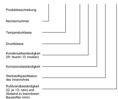
Abschnitt einer Metall-Systemabgasanlage Mehrschalig
